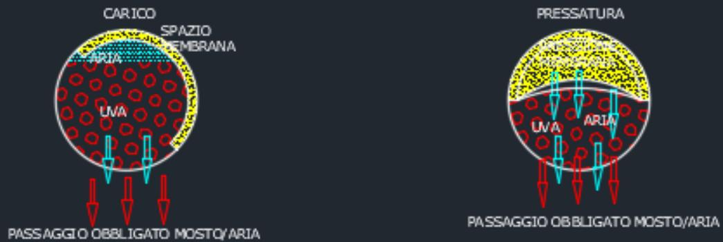
SCHEMA SINTETICO PASSAGGIO ARIA/OSSIGENO IN SERBATOIO TOTALMENTE ASOLATO
