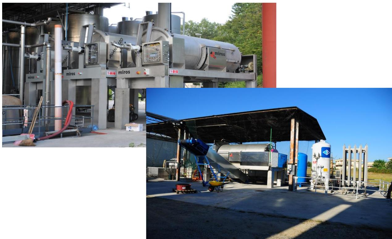
Il dispositivo consiste nell'attrezzare la pressa con apposito collettore di convogliamento mosto abbinato al sistema di accoppiamento per l'entrata del gas inerte, Il sistema consente di poter utilizzare la macchina in funzione Inertal o come pressa tradizionale selezionando l'opzione sul pannello touch screen di gestione.
