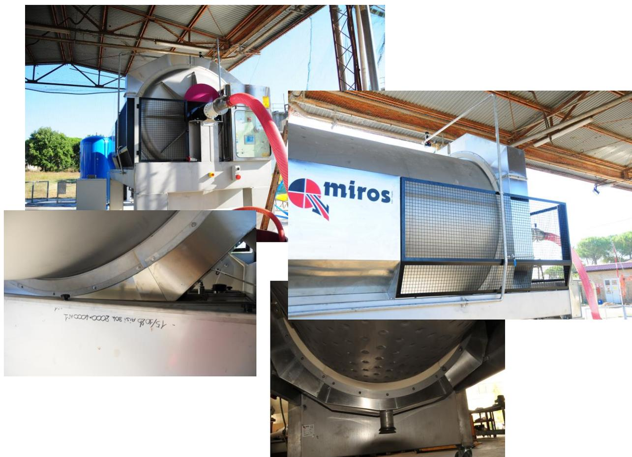
I liquidi ed il gas vengono depositati in apposito contenitore in acciaio inox in dotazione all'impianto, dal quale vengono gestiti i flussi del mosto in uscita dalla pressa. Il gas inerte da noi consigliato e con il quale viene realizzato l'impianto è l'azoto N<sub>2</sub> (azoto) densità 1,25.
